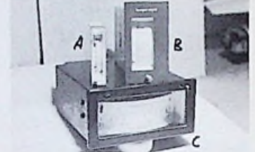
Inbouw profielmeters model A Metrawattmeter afm. 24 x 96 x 110 div. schalen: 12,50 (fabrieksprijs ± 125,- per stuk) model B Godart-meter afm. 70 x 135 x 190 mm. div. uitvoeringen 19,50 model C Norfa temp. meters 0 tot 600 graden afm. 95 x 195 x 230 mm. zonder thermokoppel 25,-
